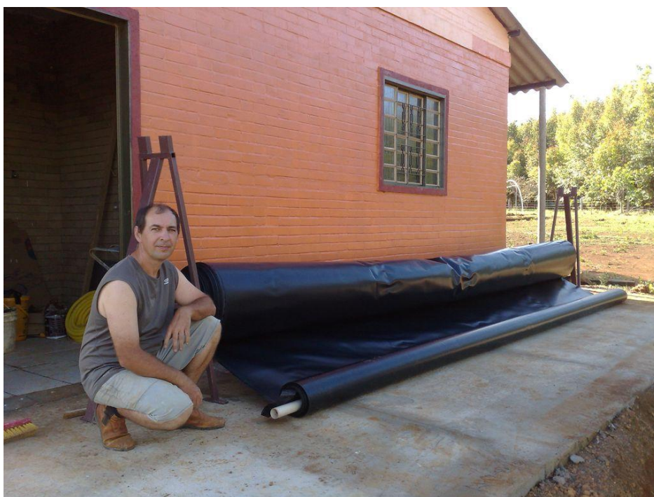
Réception de la bobine de géomembrane 500µ. 220m de long- 6m de large - 650kg. On a un peu de mal a la manipuler pour la découper en pièces de 27m de long (70kg, brulant au soleil)
